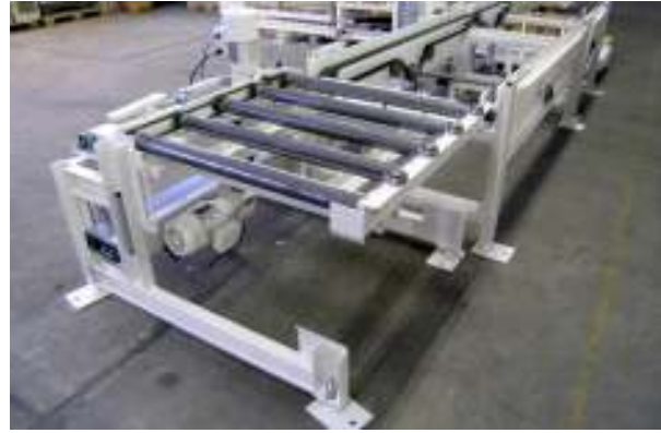
Bild 3: Zuführeinrichtung für Vergütungsöfen
